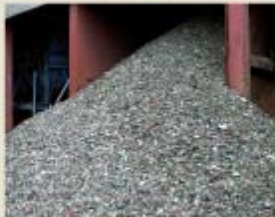
手選別後の残渣を破砕して、細分化して再資源化に利用できるようにします。
