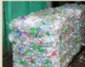
種別された物を品目ごとにプレスしてコンパクトにします。
